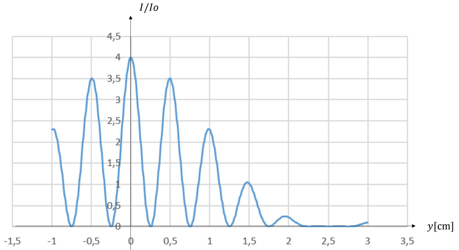
El siguiente gráfico de interferencia- difracción de Fraunhofer se obtiene al hacer incidir un frente de onda plano sobre una red de  $N$  rendijas, separadas entre sí por una distancia  $d$  y cada una de ancho  $b$ . La luz incide en forma normal a la red y tiene una longitud de onda de  $500\text{nm}$ . Con los datos del gráfico
